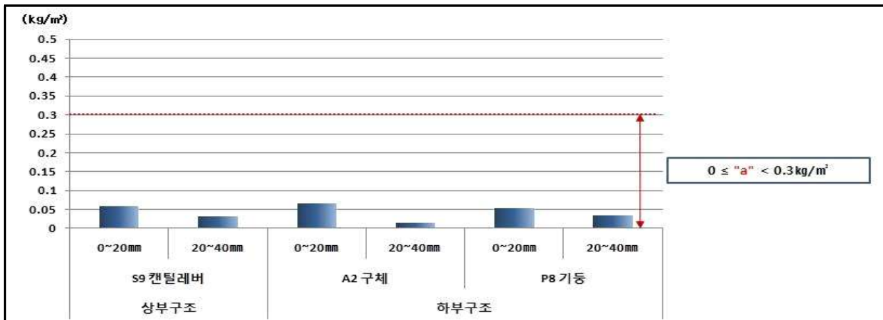
【그림 3.4.16】 염화물시험 측정결과(대구)
